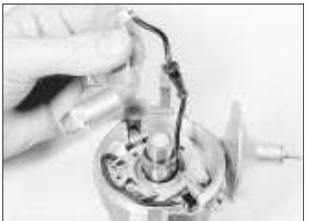
5.8 Removing the condenser (Lucas)
