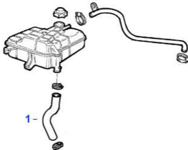
1 KWS03083 Kühlwasserschlauch unter Ausgleichs behälter 145/6,155 TS 16V
