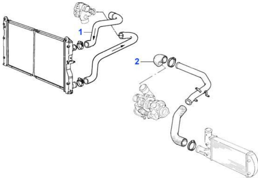
1 KWS09309 Kühlwasserschlauch oben 155 1.9 TD Bj. >96
