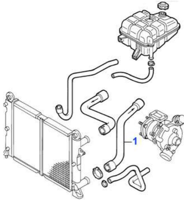
1 KWS73245 Kühlwasserschlauch 155 Kühler unten 2,0 Turbo 4X4
