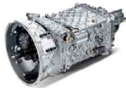
Boîte de vitesses manuelle Cambio Manual image rendering
