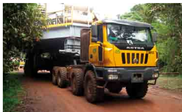
8x8 tracteur boîte 16S221 et WSK440 avec refroidissement supplémentaire 8x8 tractor cambio 16S221 y WSK440 con enfriamiento adicional
