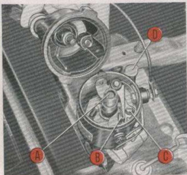
**Ogni 10.000 km:** umettare con alcune gocce di olio del motore lo stoppino **A** e lo stoppino interno all'oliatore **D**.
