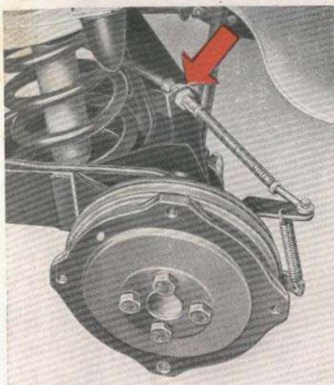
esca dal tubetto nel recipiente. Si manifesteranno nel contempo delle bollicine d'aria; cessare di azionare il pedale solo quando queste siano sparite completamente ed esca soltanto più liquido.
