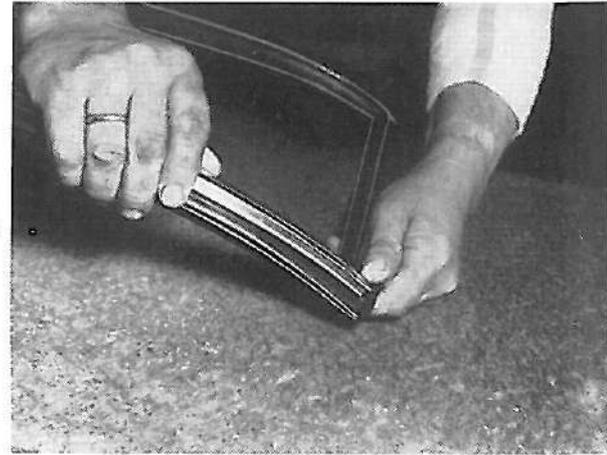
3. In Gummileiste starke Kordel einlegen in den Schlitz, in den die Führungsleiste für das Fenster zu liegen kommt. Kordelenden müssen sich unten kreuzen. Einlegen mittels Schraubenzieher, der in der Schneide bogenförmig eingeschliffen ist.
