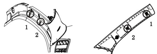
卡子位子如图所示,拆卸顺序1→2,拆卸时不可用力过猛；卡子拔出后，将A柱上饰板的下端从仪表板中轻轻取出；最后拔掉高音喇叭的线束接头。
