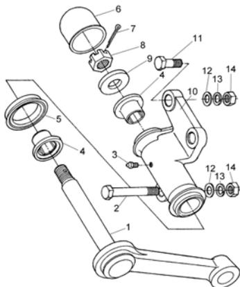
Рис. 5-15. Детали маятникового рычага с кронштейном
