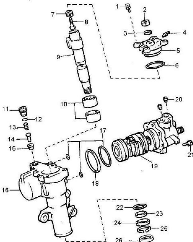
Рис. 5-12. Рулевой механизм.
