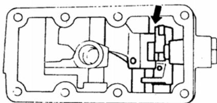
5. При установке следует выдержать определенное положение гнезда рычага.
