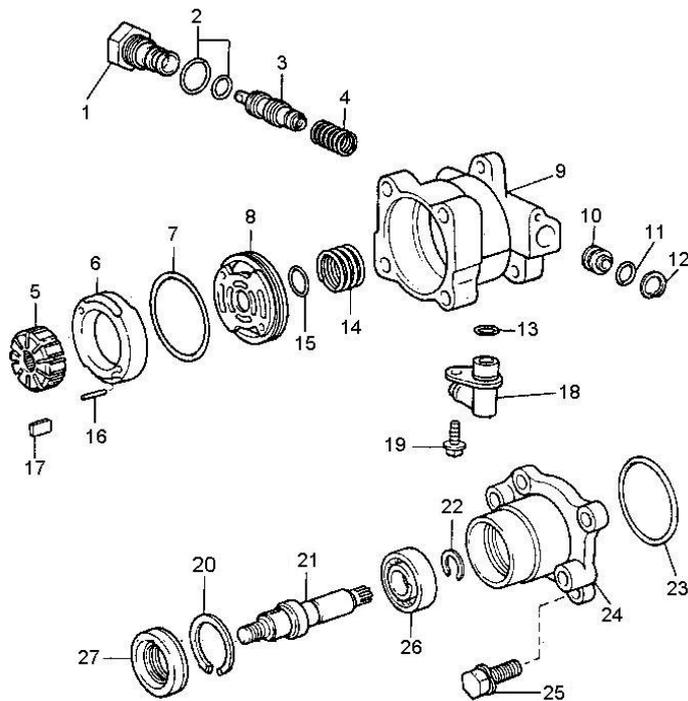
Рис. 5-20. Насос гидроусилителя рулевого управления
