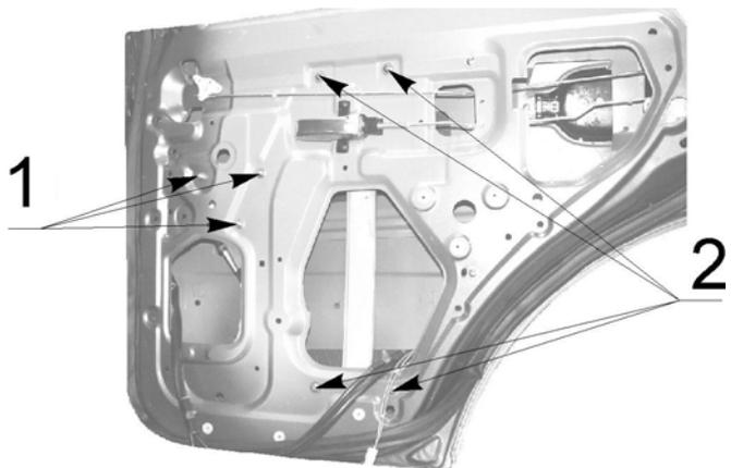
Для снятия стеклоподъемника с каркаса двери, необходимо открутить два винта, крепящих соединительную планку стеклоподъемника к обойме стекла, а также три гайки 1 (см. рисунок). Установка производится в обратной последовательности
