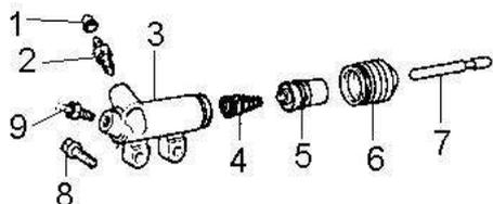
Рис. 3-16. Детали цилиндра привода выключения сцепления (рабочего цилиндра).
