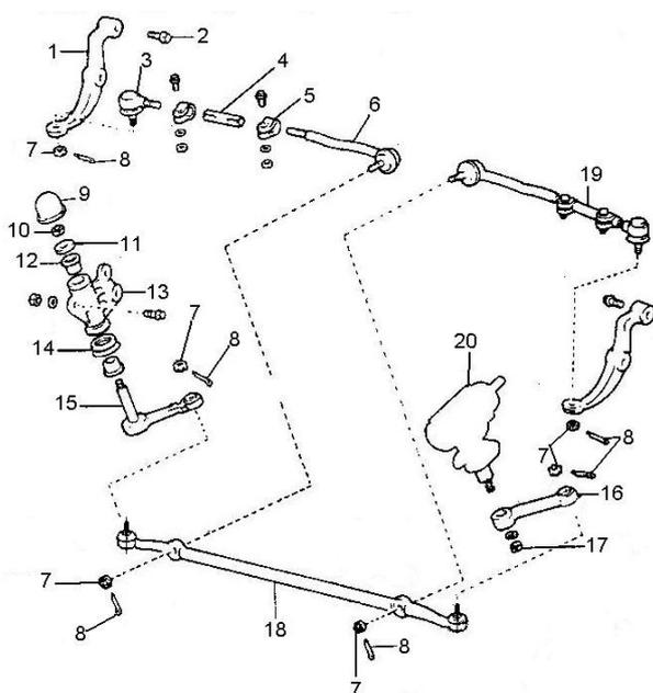
Рис. 5-4. Рулевой привод
