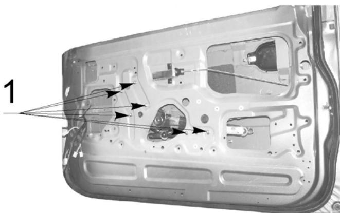
Для снятия стеклоподъемника с каркаса двери, необходимо открутить два винта, крепящих соединительную планку стеклоподъемника к обойме стекла, а также гайки 1 (см. рис.). Установка производится в обратной последовательности.
