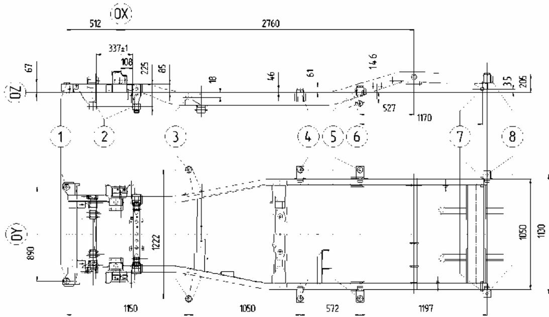
Рис. . Основные справочные размеры точек крепления кузова и подвески:
