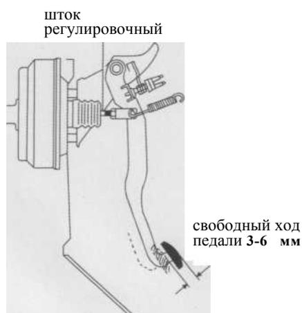
Отпустите стопорную гайку и поверните регулировочную гайку в нужном положении, затем подтяните и зафиксируйте гайку.
