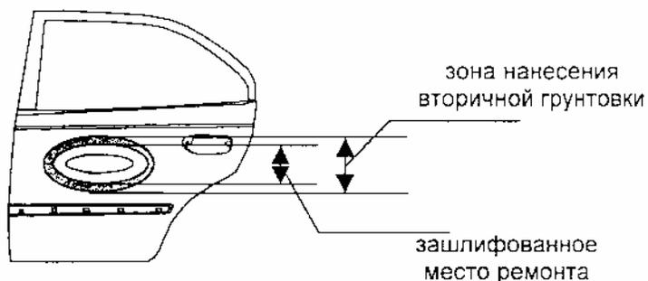
Общая толщина слоя грунтовки не должна превышать 40-50 мкм. Способ приготовления вторичной грунтовки и основные ее параметры и свойства указаны в инструкции по применению. Если ремонтируемое место не зашлифовано, то его необходимо зашлифовать шлифовальной бумагой Р600-800.
