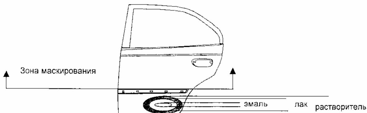
При ремонтном подкрашивании на окрашенном кузове во избежания попадания окрасочного тумана на неповрежденную поверхность необходимо замаскировать прилегающие поверхности. Ремонтное подкрашивание надо делать так, чтобы каждое последующее подкрашивание перекрывало предыдущее.
