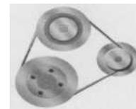
Прогиб ремня вентилятора должен составлять 7-8 мм (нового 5-7мм). Для натягивания ремня отпустите регулировочный болт на приливе двигателя, и оттяните генератор для того, чтобы натянуть ремень до указанного положения.
