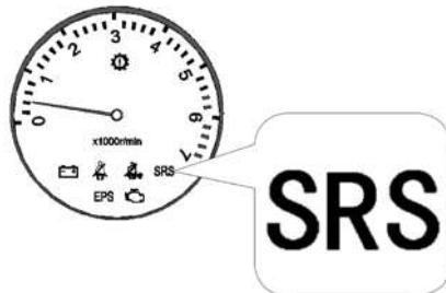
Если ключ зажигания находится в положении "ON", данный индикатор включается и выключается за несколько секунд, что свидетельствует о том, что система подушек безопасности работает должным образом.
