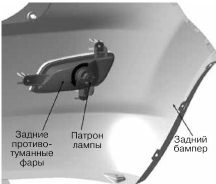
Задние противотуманные фары установлены на заднем бампере, при замене ламп, снимите сначала задний бампер, поверните патроны ламп против часовой стрелки и снимите их, затем менять лампы.
