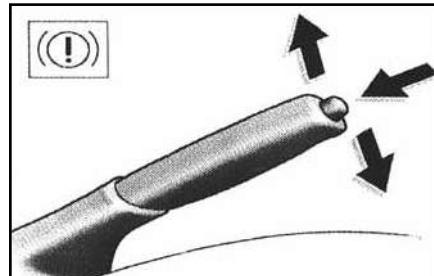
При парковке поднимите рычаг стояночного тормоза до упора во избежание случайного перемещения автомобиля.
