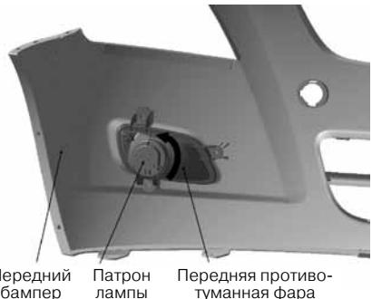
Передние противотуманные фары установлены на переднем бампере, при замене ламп, снимите сначала передний бампер, поверните патроны ламп против часовой стрелки и снимите их, затем менять лампы.
