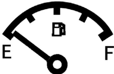
Топливомер работает, когда включено зажигание. Этот прибор может показывать примерное количество топлива, оставшееся в топливном баке.
