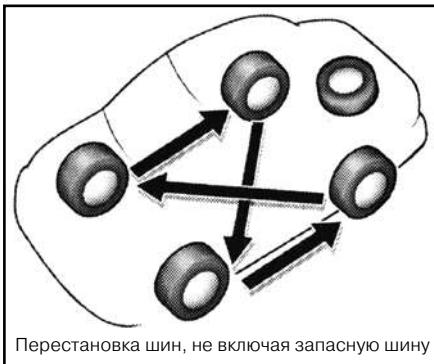
Перестановка шин, не включая запасную шину
