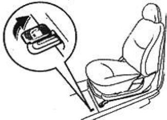
1. Потяните рычаг крышки горловины топливного бака.
