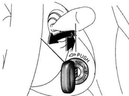
“START”: Запуск двигателя. После отпускания ключ автоматически возвращается в положение «ON».
