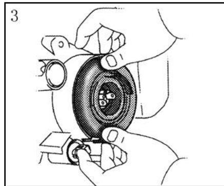
1. Поднимите капот, отсоедините адаптер и снимите резиновую крышку.
