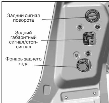
Возьмите зажим на крышке заднего комбинированного фонаря и потяните, затем снимите крышку заднего комбинированного фонаря вместе с канавкой, как показано выше на рисунке.
