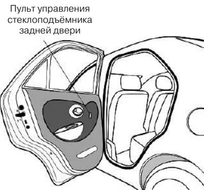
Кроме того, управлять электрическими стеклоподъёмниками задних дверей можно также с помощью выключателей стеклоподъёмников на задних дверях.
