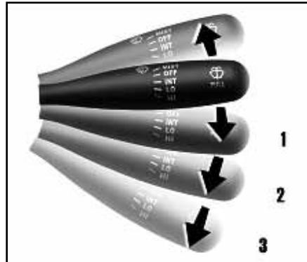
Чтобы включить стеклоочистители ветрового стекла, переместите рычаг в желаемое положение. Ключ в замке зажигания должен находиться в положении "ON"
