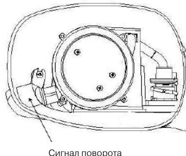
Указатели поворота встроены в наружные зеркала заднего вида, снимите патроны ламп и замените лампы после снятия наружных зеркал заднего вида.
