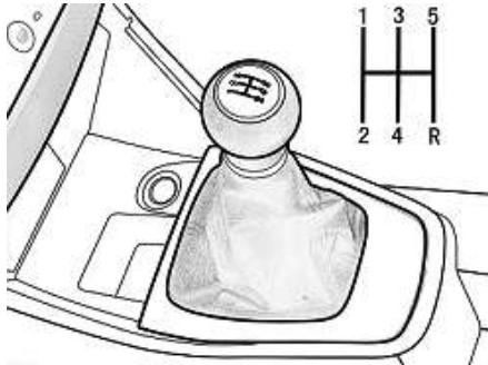
Схема переключения передач
