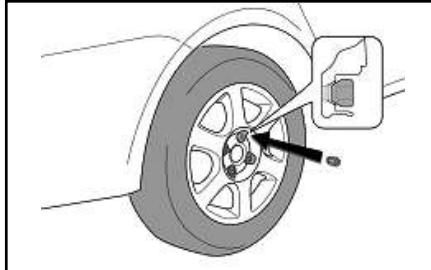
Перед установкой шины устраниТЬ посторонние включения на привалочных плоскостях колесного диска / ступицы. В противном случае, при движении автомобиля возможно появление вибрации, что может привести к ослаблению крепящего момента колесных болтов, как результат самопроизвольное отворачивание и потеря колеса. Следовательно, необходимо проверить, момент затяжки колесных болтов / гаек, после пробега автомобиля 1 600 км с момента установки данного колеса.
