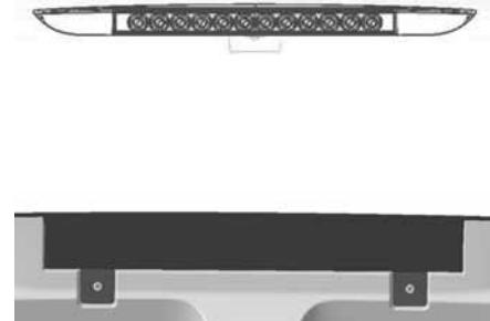
Источником света дополнительного центрального стоп-сигнала является светодиод, который не нужно заменять. Он крепится в нижней части накладки двумя самонарезающими винтами.
