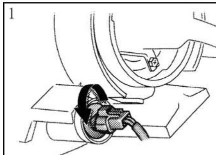
Поверните против часовой стрелки, чтобы снять патрон лампы.
