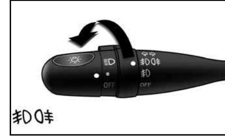
противотуманных фар. В то же время, индикаторы передней и задней противотуманной фары на приборной панели сообщают о включении передних и задних противотуманных фар.
