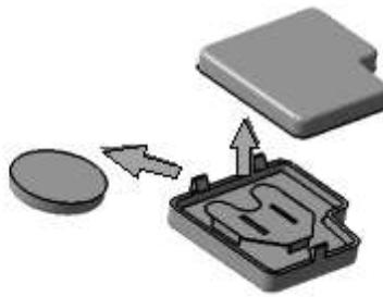
2. Снимите крышку передатчика с помощью инструментов, вытяните батарею, а затем вставьте новую батарею в передатчик, с поверхностью (+) направленной вверх.
