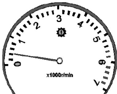
Тахометр показывает скорость двигателя в тысячах оборотов в минуту. Скорость может помочь водителю выбрать точный момент переключения передачи чтобы предотвратить перегрузку или превышение допустимого числа оборотов двигателя. Слишком большое число оборотов двигателя может привести к чрезмерному износу и увеличению расхода топлива двигателя. Необходимо помнить, что при максимально возможной низкой скорости вращения двигателя можно достичь максимальной экономии топлива в большинстве случаев
