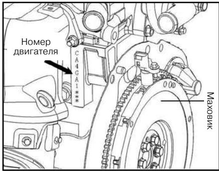
Номер двигателя указан на корпусе двигателя, и его расположение показано на рисунке.
