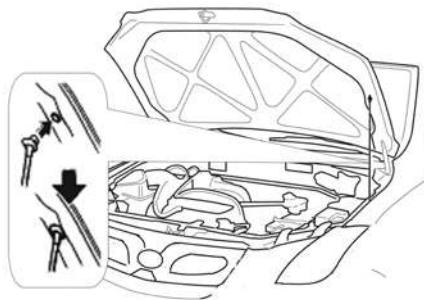
3. Зафиксируйте капот в открытом положении путём установки поддерживающего стержня в паз на капоте двигателя.
