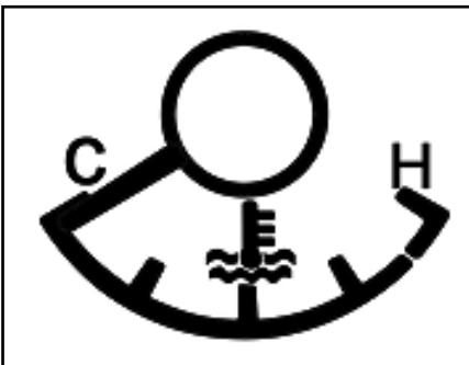
Указатель температуры охлаждающей жидкости работает, когда ключ зажигания находится в положении "ON". Он может показывать приблизительную температуру хладагента в блоке цилиндров.
