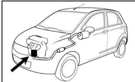
Трёхкомпонентный каталитический нейтрализатор отработавших газов является устройством снижения токсичности отработавших газов, которое установлено в выхлопной системе двигателя.
