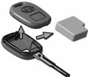
1. Снимите крышку ключа с помощью инструментов и вытяните передатчик из ключа.
