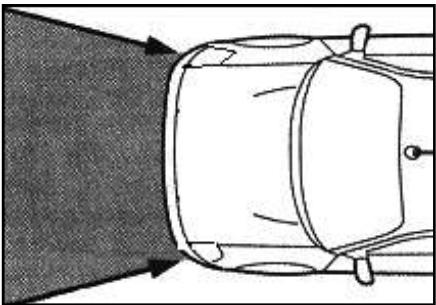
Подушки безопасности предназначены для срабатывания при сильном фронтальном ударе (затенённая область между стрелками на рисунке).
