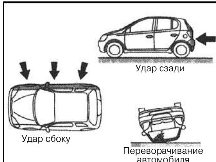
Подушки безопасности, как правило, не предназначены для раскрывания в случаях, если автомобиль был подвергнут удару сбоку или сзади, или переворачиванию, или лобовому удару на малой скорости.
