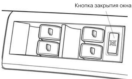
Четыре выключателя стеклоподъёмника на пульте управления могут соответственно управлять окнами четырёх дверей, когда ключ зажигания должен быть в рабочем положении "ON".
