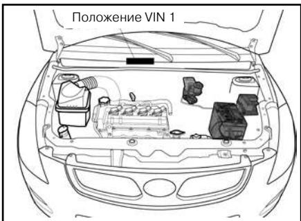
Идентификационный номер автомобиля (VIN) является официальным опознавательным знаком вашего автомобиля. Он находится на передней стенке отсека двигателя и на левой верхней стороне приборной панели, и его местоположение указано на рисунках выше.
