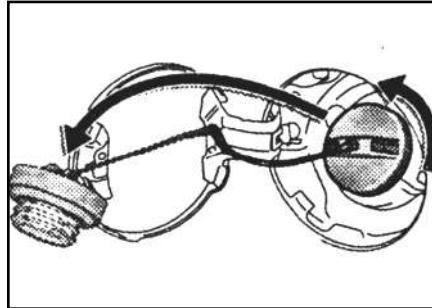
2. При снятии крышки горловины топливного бака, медленно поверните её против часовой стрелки и подождите некоторое время, прежде, чем снять её.
