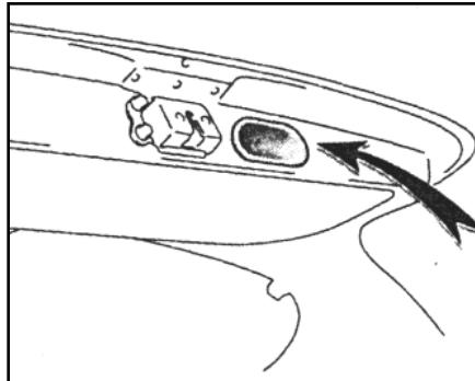
Задняя дверь беспрепятственно закрывается при использовании углублённой ручки на задней двери.
