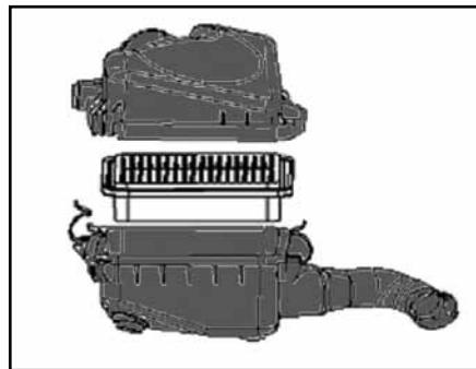
Проверяйте и заменяйте воздушный фильтр двигателя, согласно требованиям, При замене воздушного фильтра, очистите блок фильтра.
