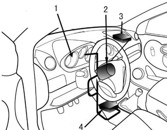
1. Сигнальная лампа подушки безопасности на приборной панели
