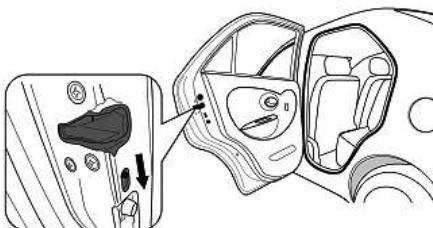
Потяните зажимной стержень к нижней части зажимной канавки.
