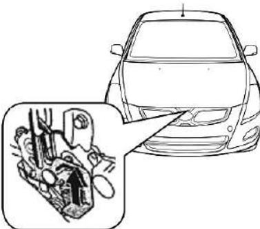
2. Станьте спереди автомобиля, поднимите вручную вспомогательную рукоятку с защёлкой и поднимите капот двигателя.
