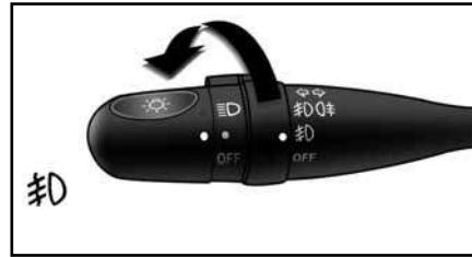
Включите передний габаритный фонарь, поверните переключатель противотуманных фар в указанное для передних противотуманных фар положение. В то же время, индикатор передних противотуманных фар на приборной панели укажет на то, что включились передние противотуманные фары.
