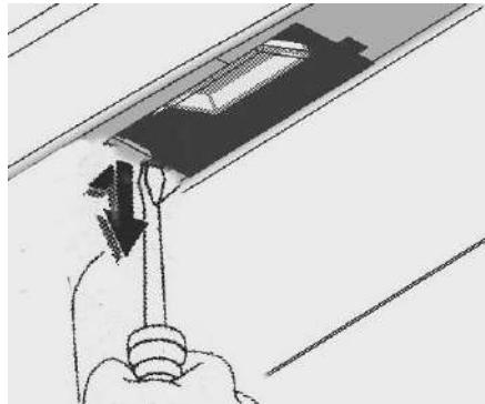
Снимите освещение номерного знака используя отвёртку.
