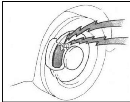
Указатели предела износа фрикционной тормозной накладки на ваших дисковых тормозах издают предупреждающий шум, когда фрикционные тормозные накладки требуют замены по причине износа.
