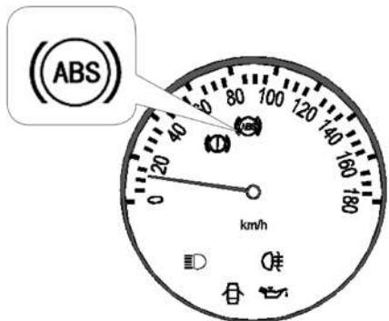
Когда горит световой сигнал "ABS" (при выключенном сигнале тормозной системы), это говорит о том, что антиблокировочная тормозная система не работает. Следовательно, колеса заблокируются при резком торможении или торможении на скользкой дороге.
