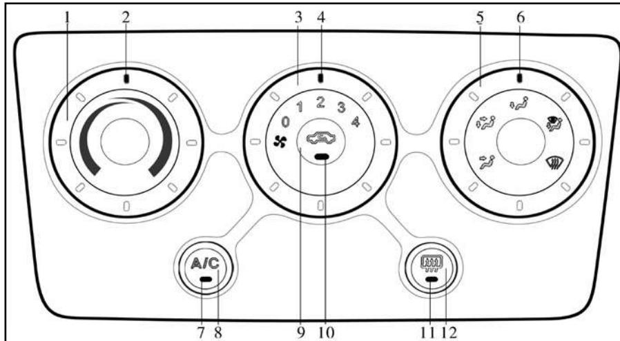
1. Переключатель регулировки температуры
