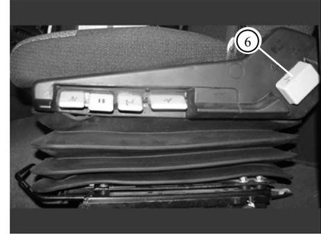
▶ ⑥ Регулировка угла наклона спинки сиденья
