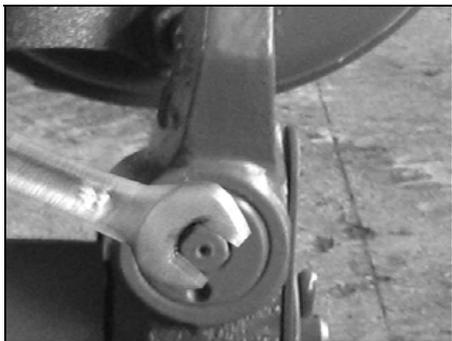
— Поверните шестигранную головку червяка регулировочного рычага по часовой стрелке до упора с помощью ключа до упора (до момента контакта фрикционной накладки с тормозным барабаном), потом поверните шестигранную головку червяка против часовой стрелки на 3/4 оборота (при вращении против часовой стрелки может быть услышан щелк).
