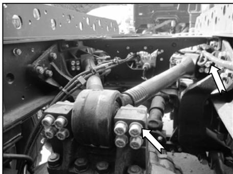
— Проверьте и затяните болты, гайки крепления верхнего торсиона, моменты затяжки приведены в следующей таблице.
