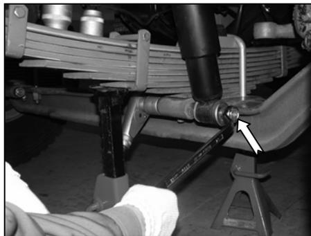
— Проверьте и затяните гайку крепления пальца амортизатора, момент затяжки гайки приведен в следующей таблице.
