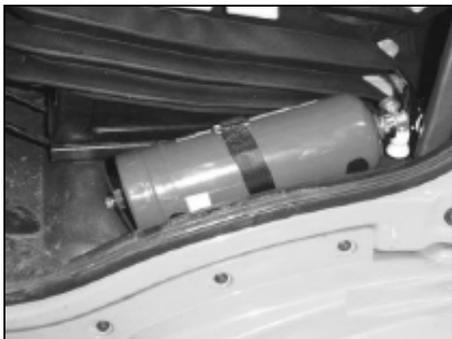
▶ Огнетушитель расположен на кронштейне пола слева от водительского сиденья и фиксируется крепежным ремнем.
