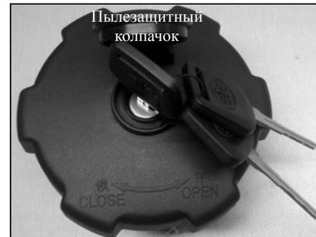
**Управление замком крышки люка топливного бака**
