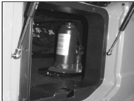
▶ Домкрат размещен в ящике для инструментов, расположенном в правой задней части с внешней стороны кабины.
