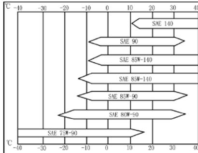
График вязкости моторного масла, в зависимости от температуры окружающего воздуха.
