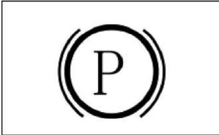
**Контрольная лампа неисправности тормозной системы**
