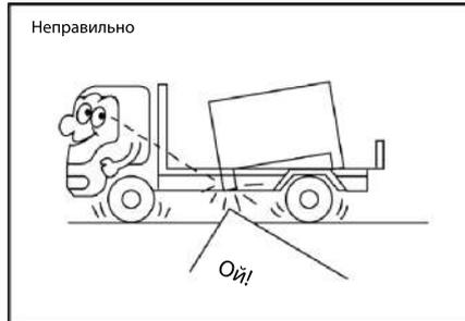
При перевозке насыпных грузов следует использовать бортовые решетки для обоих бортов.
