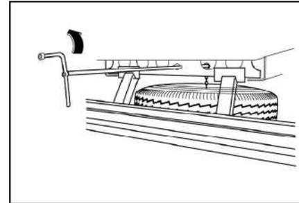
Чтобы повесить запасное колесо, нужно повернуть рукоятку по часовой стрелке до упора, а затем затянуть, чтобы колесо было крепко зафиксировано в исходном положении.
