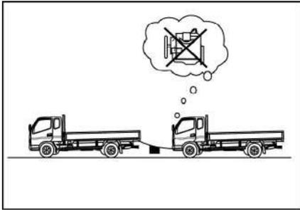
Запрещается пуск двигателя путем буксировки другим автомобилем. Это может привести к аварийной ситуации. Для того чтобы завести автомобиль с полностью разряженным аккумулятором, можно использовать другой аккумулятор с такими же характеристиками.
