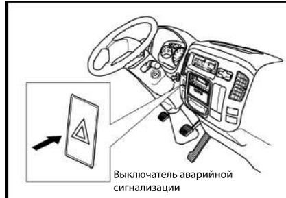
Выключатель аварийной сигнализации
