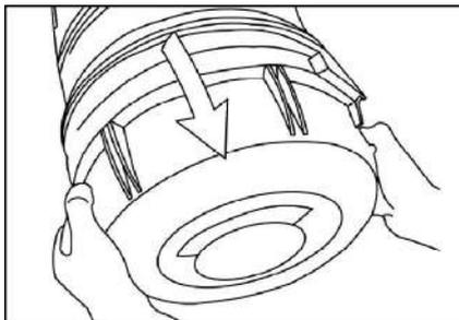
3 Выньте фильтрующий элемент из корпуса.
