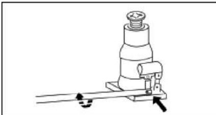
Когда рычаг домкрата находится в положении, показанном на иллюстрации, медленно откручивайте пробку маслотоворного отверстия против часовой стрелки.
