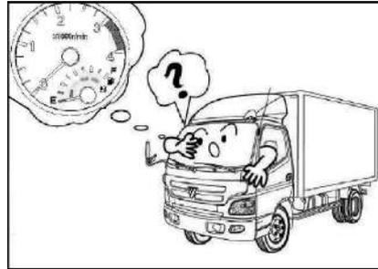
Если топливо в топливном баке полностью закончилось, существует вероятность попадания воздуха в топливную систему. В таком случае подача топлива к двигателю может быть ухудшена. Чтобы предотвратить такое явление, следует выпустить воздух из топливной системы.
