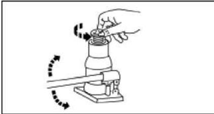
Если площадка домкрата находится под опорной точкой, то проворачивайте ее против часовой стрелки, чтобы отрегулировать высоту.
