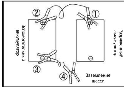
После того как к аккумуляторной батарее подсоединен провод от другой батареи, заведите двигатель неисправного автомобиля.
