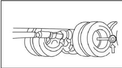
Отсоедините карданный вал от фланца заднего моста и прикрепите его к раме или поперечине, чтобы не повредить трансмиссию.
