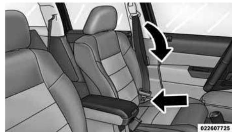
**Установка запорной скобы в замок**
