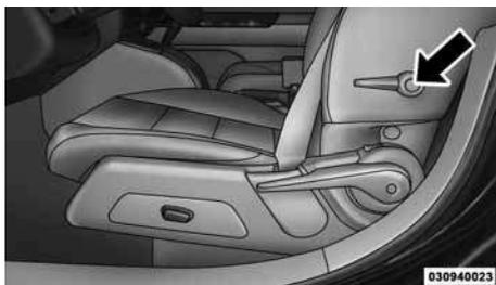
Рычаг регулировки валика поясничной поддержки
