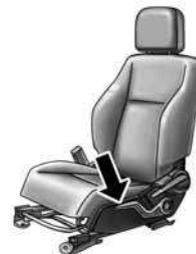
Рычаг регулировки сиденья по высоте
