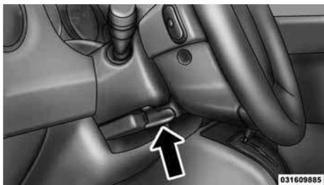
Рычаг регулируемой рулевой колонки
