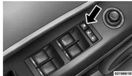
Кнопка блокировки клавиш управления стеклоподъемниками
