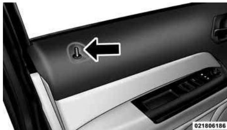
Кнопка блокировки дверного замка
