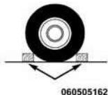
6. Подставьте с двух сторон под колесо, которое находится по диагонали от поврежденного, противооткатные упоры. Например, если заменяется правое переднее колесо, то упоры следует поставить под левое заднее колесо.
