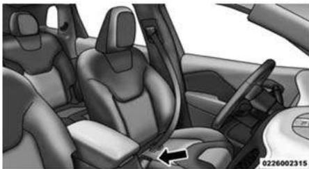
Установка запорной скобы в замок
