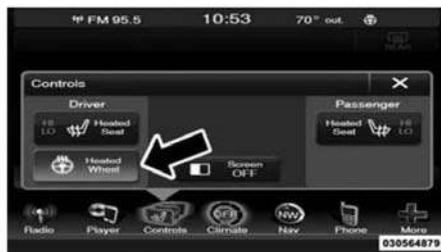
Экранная кнопка Heated Steering Wheel (Обогрев рулевого колеса)
