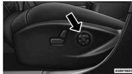
Выключатель регулировки положения валика поясничной поддержки
