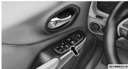
Клавиши управления электрическими стеклоподъемниками
