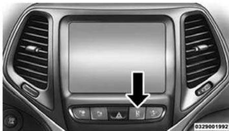
Выключатель системы предупреждения о непреднамеренной смене полосы движения
