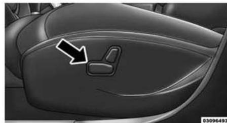
Выключатель электропривода регулировки положения сиденья
