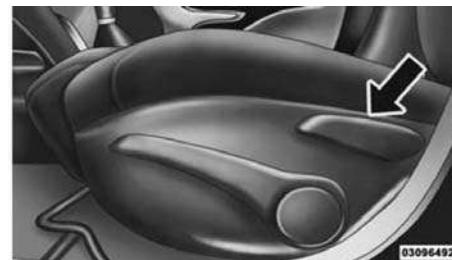
**Рычаг регулировки наклона спинки сиденья**
