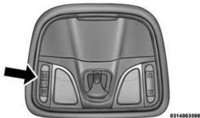
Выключатель электропривода крышки люка
