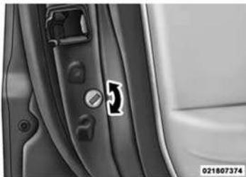
Функция блокировки замков от открывания задних дверей изнутри автомобиля
