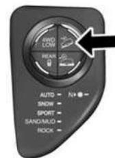
Система помощи при движении под уклон
