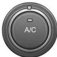
Вращая этот регулятор, вы можете регулировать температуру воздуха в пассажирском салоне. Поверните регулятор из центрального положения по часовой стрелке в зону с синей шкалой для охлаждения воздуха, поступающего в салон. Поверните регулятор из центрального положения против часовой стрелки в зону с красной шкалой для подогрева воздуха, поступающего в салон.
