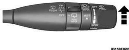
Направление вращения рукоятки для включения очистителя ветрового стекла на один цикл
