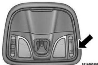
Выключатель электропривода шторки
