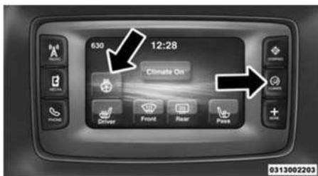
Экранная кнопка Heated Steering Wheel (Обогрев рулевого колеса)
