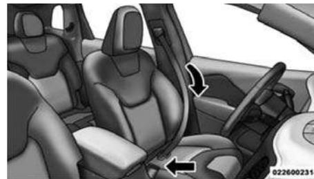
**Вытягивание запорной диагонально-поясного ремня безопасности за скобу**
