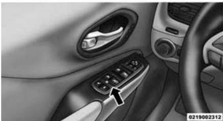
Кнопка блокировки клавиш управления стеклоподъемниками
