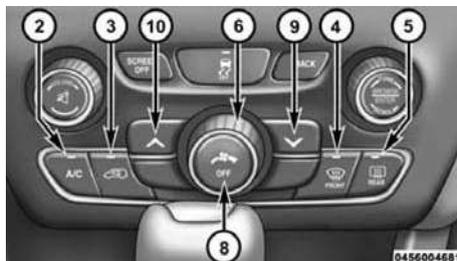
Кнопки управления системой вентиляции, отопления и кондиционирования Uconnect®
