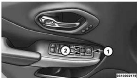
Переключатель электропривода регулировки зеркал
