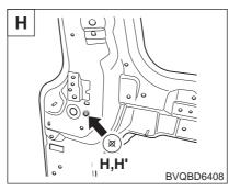
Power sliding door module mounting hole (Ø9)
