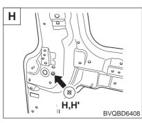
Power sliding door module mounting hole (Ø9)
