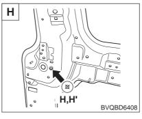
Power sliding door module mounting hole (Ø9)
