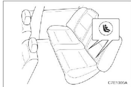
4. Установите детское кресло на сиденье над двумя нижними узлами крепления и закрепите его, соблюдая инструкции производителя данного детского кресла.
