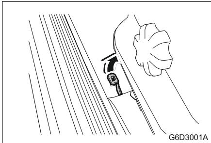
3. Медленно поверните крышку заправочной горловины против часовой стрелки. В случае появления шипящего звука дождитесь его прекращения, прежде чем полностью отвинчивать крышку. Откидная крышка топливного бака расположена на задней правой панели боковины.
