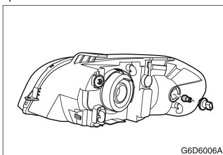
6. Установите в патрон исправную лампу. См. раздел "ХАРАКТЕРИСТИКИ ЛАМП".
