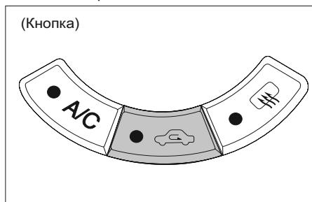
Использование режима рециркуляции воздуха в течение длительного времени может привести к запотеванию стекол автомобиля. В этом случае повторно нажмите выключатель режима рециркуляции воздуха для возобновления поступления воздуха с улицы.
