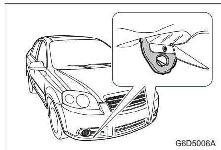
Буксировка таким способом может осуществляться только по дороге с твердым покрытием, на короткие расстояния и при малой скорости.
