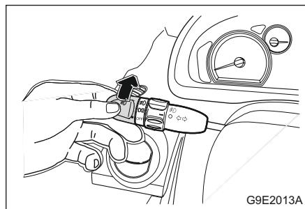
Фары выключаются автоматически при повороте ключа зажигания в положение LOCK или ACC.
