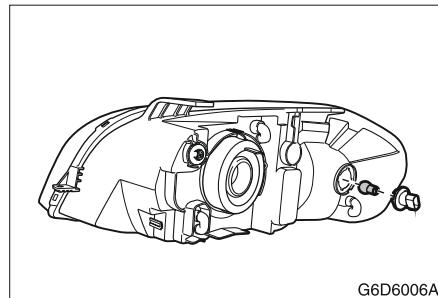
3. Вращайте патрон лампы указателя поворота против часовой стрелки.
