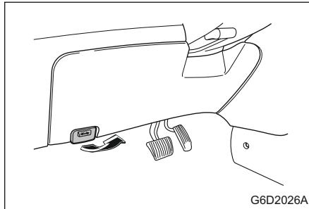
2. Потяните вверх ручку под передней кромкой капота и поднимите капот.
