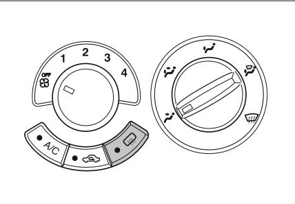
Для включения обогревателя включите зажигание и нажмите кнопку обогревателей заднего стекла и наружных зеркал\*. На кнопке загорится световой индикатор.
