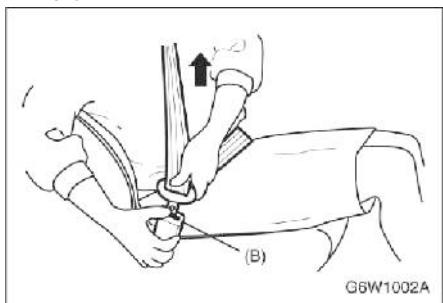
При складывании заднего сиденья вставьте ключ или подходящий узкий инструмент в паз (1) в замке и дайте ремню втянуться.
