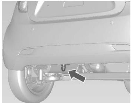
Задняя буксировочная проушина расположена под задним бампером автомобиля.
