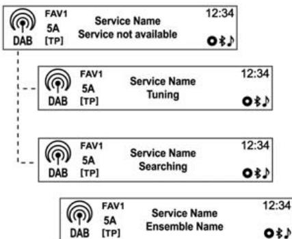
Для перехода в меню DAB в режиме DAB нажмите кнопку **MENU** (Меню). Поворотом ручки управления **TUNE** выберите режим ручной настройки на станцию DAB и нажмите кнопку **MENU** (Меню). Поворотом ручки **TUNE** (Настройка) найдите нужную частоту, после чего нажмите на кнопку **MENU** (Меню).
