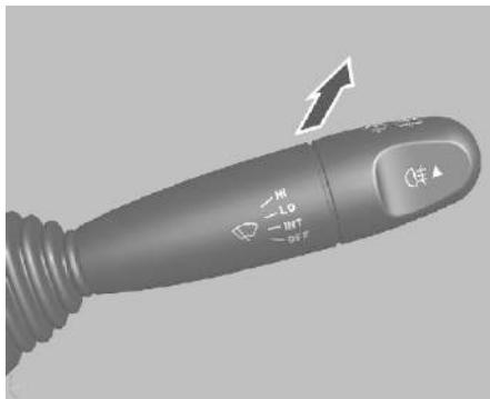
Для включения очистителя / омывателя заднего стекла сдвиньте рычаг к приборной панели. Одно нажатие: стеклоочиститель будет работать непрерывно на низкой скорости. Для разбрзгивания жидкости омывателя нажмите рычаг еще раз.
