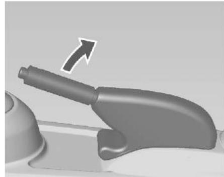
Не нажимая кнопку фиксатора, сильно затяните стояночный тормоз. На спуске или подъеме стояночный тормоз следует затягивать с максимальным усилием.
