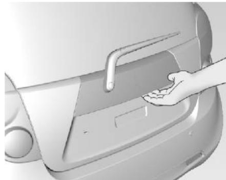
Чтобы закрыть заднюю дверь, опустите ее и захлопните. Затем вставьте ключ в замочную скважину и поверните по часовой стрелке.
