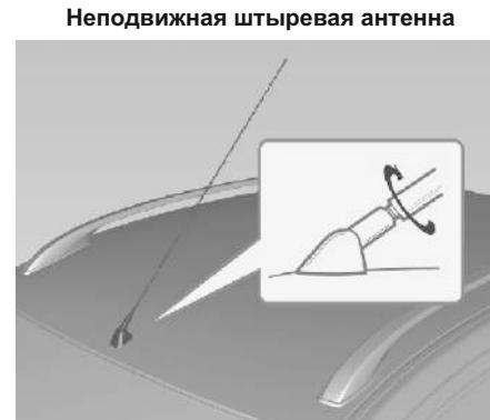
Для снятия вращайте антенну на крыше против часовой стрелки. Для установки вращайте антенну по часовой стрелке.
