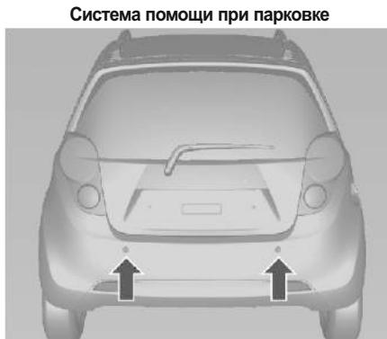
Система помощи при парковке служит для помощи водителю при движении задним ходом: при обнаружении за автомобилем препятствия звучит звуковой сигнал.
