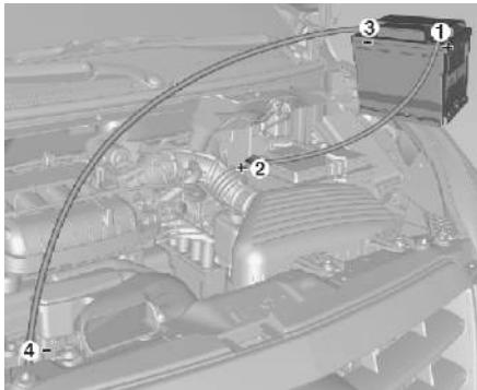
Порядок подключения проводов.
