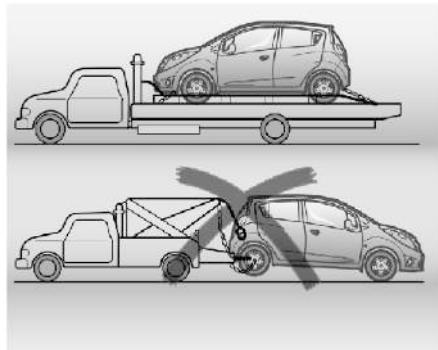
Наилучший способ транспортировки - использование автомобиля-эвакуатора.
