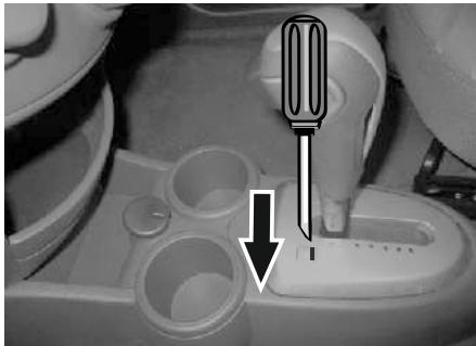
4. Вставьте отвертку в отверстие до упора и выведите селектор из положения "Р". Запустите двигатель и включите требуемую передачу.
