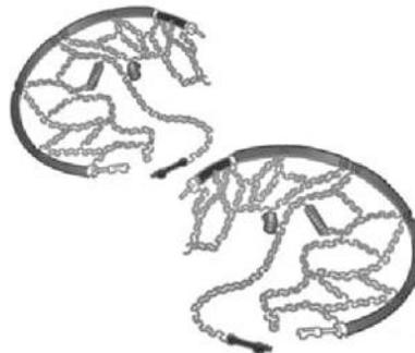
Допускается установка колесных цепей только на передних колесах. Используйте цепи противоскольжения с мелкими звеньями, которые выступают за протектор и внутреннюю сторону шины не более 10 мм.
