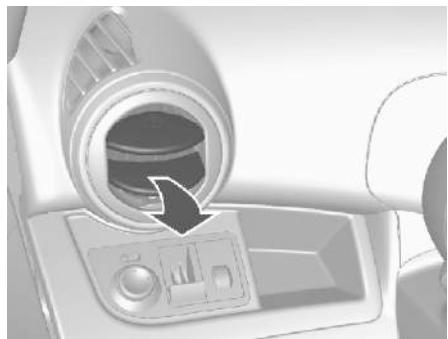
Чтобы открыть боковые вентиляционные отверстия, нажмите на крышку каждого отверстия и поверните ее в нужном направлении.
