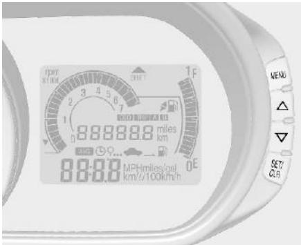
Бортовой компьютер сообщает водителю различные данные о движении автомобиля - запас хода по остатку топлива, наружную температуру, среднюю скорость, время движения.
