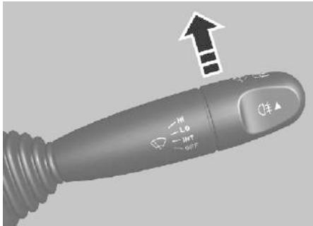
Для включения очистителя лобового стекла поверните ключ зажигания в положение ON и переведите вверх рычаг очистителя / омывателя лобового стекла.
