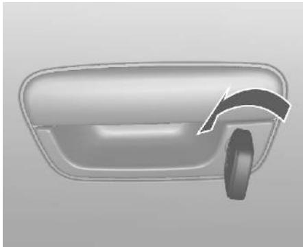
Отоприте дверь водителя вручную поворотом ключа в замке.
