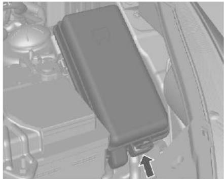
Блок плавких предохранителей находится в моторном отсеке.
