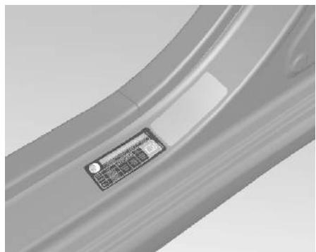
Давление в шинах  $\diamond$  стр. 11-5 и на табличке на дверном проеме водителя.
