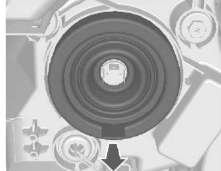
2. Снимите защитную крышку.
