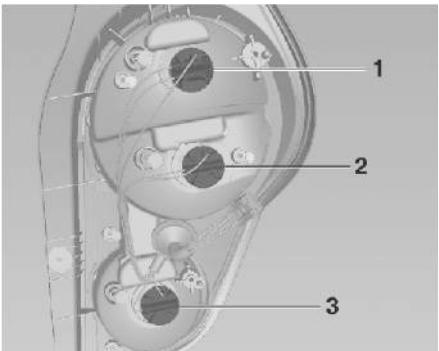
3. Задний габаритный огонь / стоп-сигнал (1),
