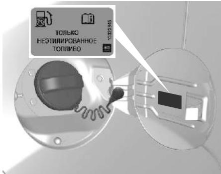
4. Снимите крышку. Крышка привязана к автомобилю.
