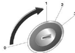
**0 (LOCK)** (блокировка): зажигание выключено
