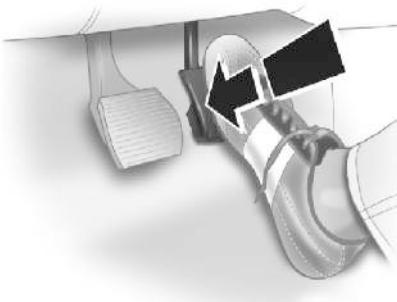
Для более резкого ускорения нажмите педаль акселератора до упора и удерживайте в таком положении. Коробка передач переведется на более низкую передачу в зависимости от оборотов двигателя.
