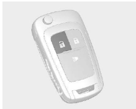
При отпирании автомобиля нажатием кнопки противоугонная сигнализация отключается.
