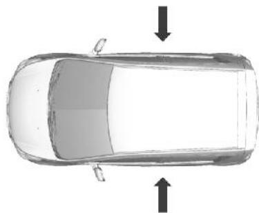
Система боковых подушек безопасности срабатывает в случае достаточно сильного столкновения. Зажигание должно быть включено.
