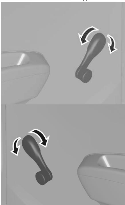
Дверные окна могут открываться или закрываться при помощи рукояток стеклоподъемников.
