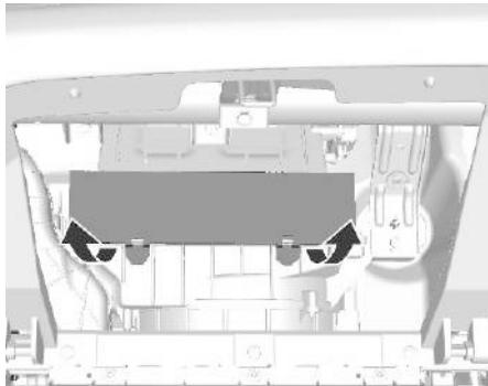
2. Приподнимите и снимите крышку фильтра.
