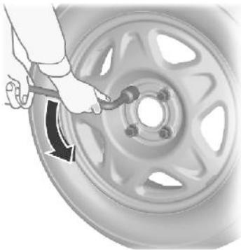
2. Разложите колесный ключ и установите его, убедившись, что он стоит надежно; затем ослабьте каждую колесную гайку на пол-оборота.
