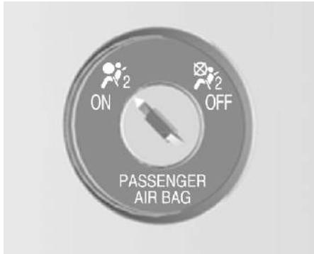
Система подушек безопасности переднего пассажира отключается с помощью выключателя, расположенного сбоку на панели приборов, доступ к которому обеспечивается при открывании двери переднего пассажира.
