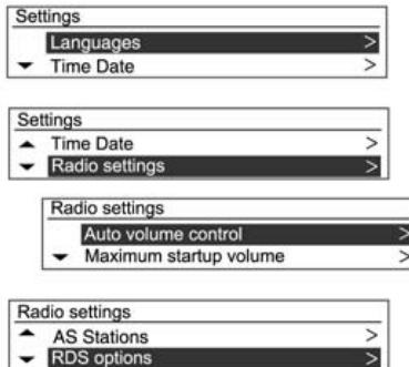
Нажмите клавишу **CONFIG** (Конфигурация), чтобы отобразить меню Настройки. Поверните ручку управления **TUNE** (Настройка) для перехода к настройкам радиоприемника, затем нажмите кнопку  **MENU** (Меню). Поворотом ручки управления **TUNE** (Настройка) выберите настройки RDS, затем нажмите кнопку  **MENU** (Меню).
