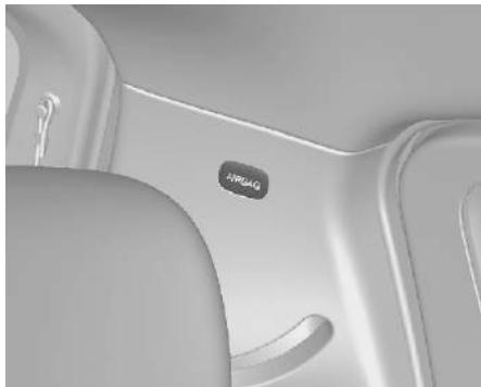
Система шторок безопасности состоит из подушек безопасности в конструкции крыши с каждой ее стороны. Эти места могут быть обозначены словом AIRBAG (подушка безопасности) на опорах крыши.
