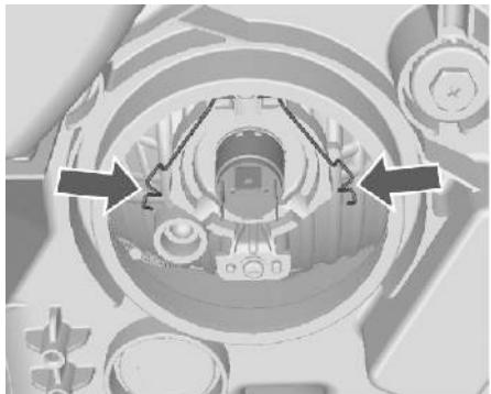
3. Нажмите на пружинный зажим и разъедините его.
