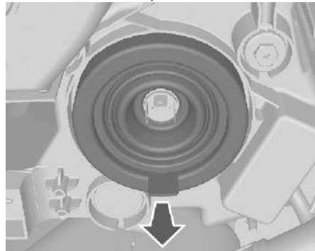
2. Снимите защитную крышку.
