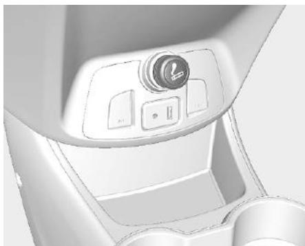
Для использования прикуривателя поверните замок зажигания в положение АСС или ВКЛ и нажмите на прикуриватель до упора.
