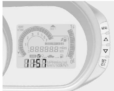
Время отображается на панели приборов. Если в комбинации приборов нет часов, время отображается в информационно-развлекательной системе.
