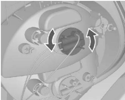
4. Поверните патрон лампы против часовой стрелки.
