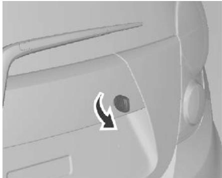
Для отпирания двери багажника вставьте ключ в замочную скважину, поверните против часовой стрелки и потяните длинную ручку.
