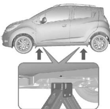
3. Вращая рукоятку домкрата, слегка приподнимите подъемную головку и установите домкрат вертикально в месте, отмеченном полукругом.
