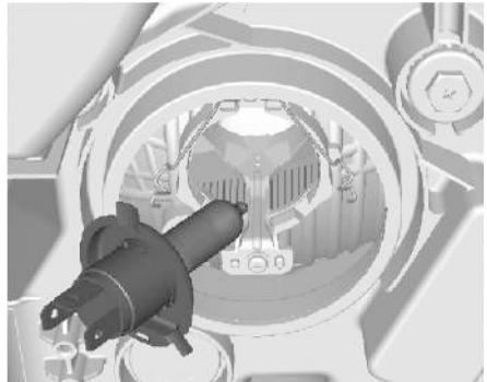
4. Извлеките лампу из корпуса отражателя.
