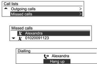
Поворачивая ручку **TUNE** (Настройка), просмотрите историю вызовов и выберите номер для соединения. Нажмите кнопку **MENU**, чтобы позвонить по номеру, выбранному в истории вызовов.
