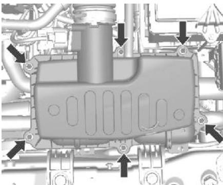
1. Вывинтите винты и снимите крышку.
