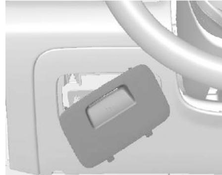
2. Снимите дверцу панели предохранителей, сдвигая её по диагонали.
