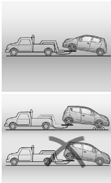
При буксировке на 2 колесах поднять передние ведущие колеса и буксировать с блокированными передними колесами. При буксировке автомобиля необходимо соблюдать следующие правила:
