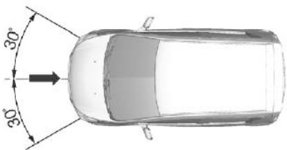
В случае удара определенной силы, приходящегося на указанную область, происходит срабатывание передних подушек безопасности. Зажигание должно быть включено.
