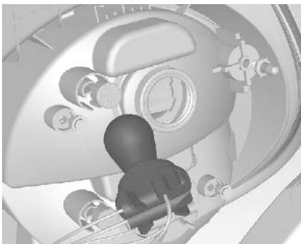
5. Извлеките патрон лампы. Слегка нажмите на лампу в направлении гнезда, поверните ее против часовой стрелки, извлеките и замените на новую.
