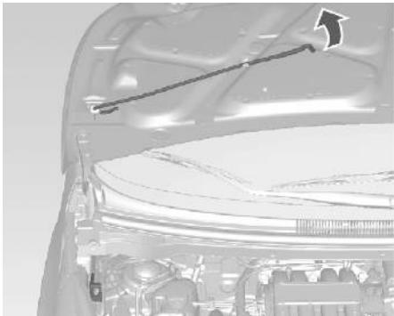
3. Слегка потяните из держателя вверху стержень опоры. Затем зацепите его за крючок в левой части отсека двигателя.
