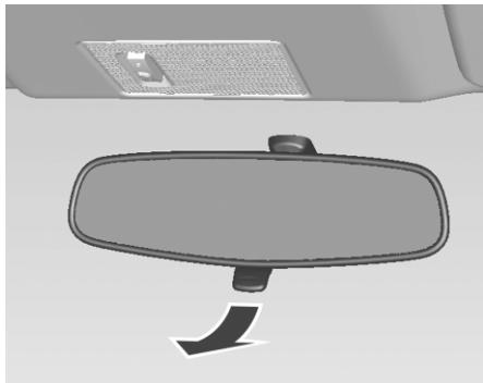
Для уменьшения бликов потяните рычаг на нижней части корпуса зеркала.
