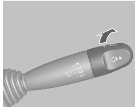
Для включения задних противотуманных фонарей поверните выключатель на конце рычага очистителя/омывателя ветрового стекла при включенном ближнем свете.
