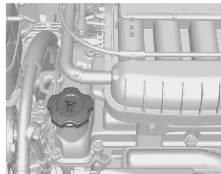
Крышка маслоналивной горловины двигателя находится на крышке распределителя.
