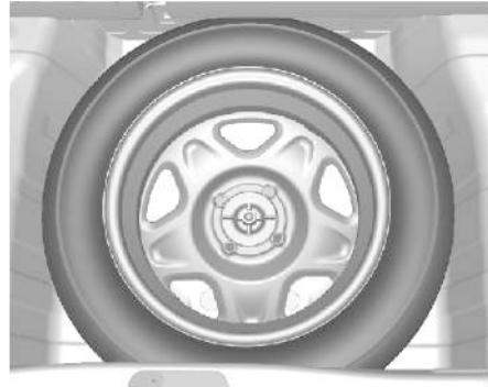
Запасное колесо хранится в багажном отделении под ковриком пола. Оно крепится в нише с помощью барашковой гайки.
