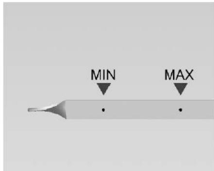
8. Проверьте уровень жидкости. Жидкость на щупе должна находиться между отметками **MIN** и **MAX**, как показано на рисунке.
