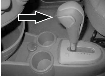
**P (СТОЯНКА):** Блокируются передние колеса. Переключайтесь в положение P только на стоящем автомобиле и при задействованном стояночном тормозе.
