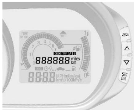
Одометр показывает пробег автомобиля в километрах или милях.
