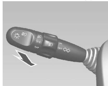
Для включения или отключения передних и задних габаритных фонарей поверните головку многофункционального рычага. У выключателя освещения три положения, активирующие следующие функции:
