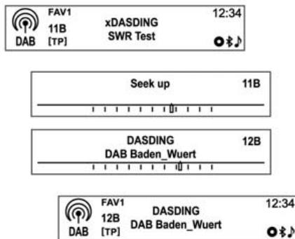
Нажмите кнопку (Перемотка) для автоматического поиска доступных компонентов DAB с хорошим приемом.
