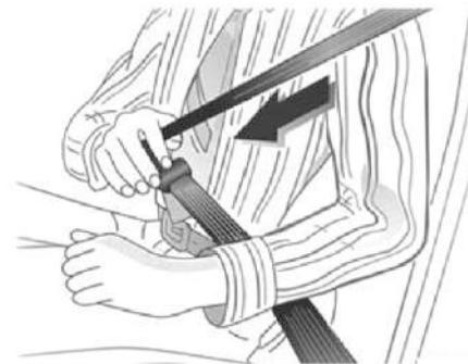
Извлеките ремень из катушки, протяните без перекручивания вдоль торса и вставьте язычок крепления в замок.
