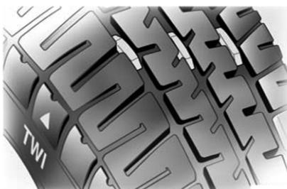
Если износ передних колес больше износ задних колес, поменяйте колеса местами.
