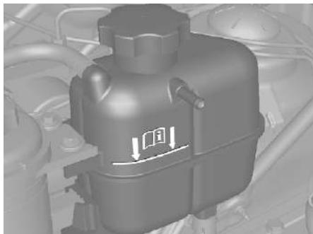
Если система охлаждения холодная, уровень охлаждающей жидкости должен быть выше заправочной метки. Если уровень слишком низкий, долейте охлаждающую жидкость.
