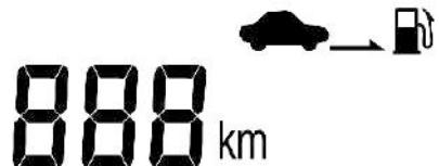
В этом режиме отображается примерное расстояние, которое автомобиль может проехать до полного опустошения топливного бака.
