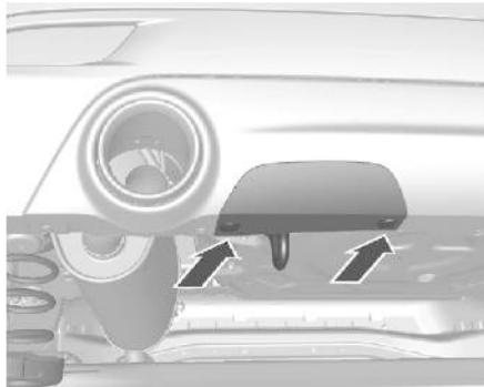
Задняя буксировочная проушина расположена под задним бампером автомобиля.
