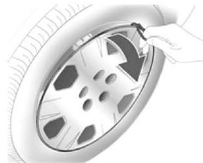
1. Подцепите колпачки колесных гаек отверткой и снимите их.
