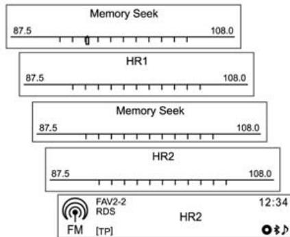
Нажмите одну из кнопок **[SEEK]** (Поиск) для автоматического поиска доступных радиостанций с хорошим приемом.
