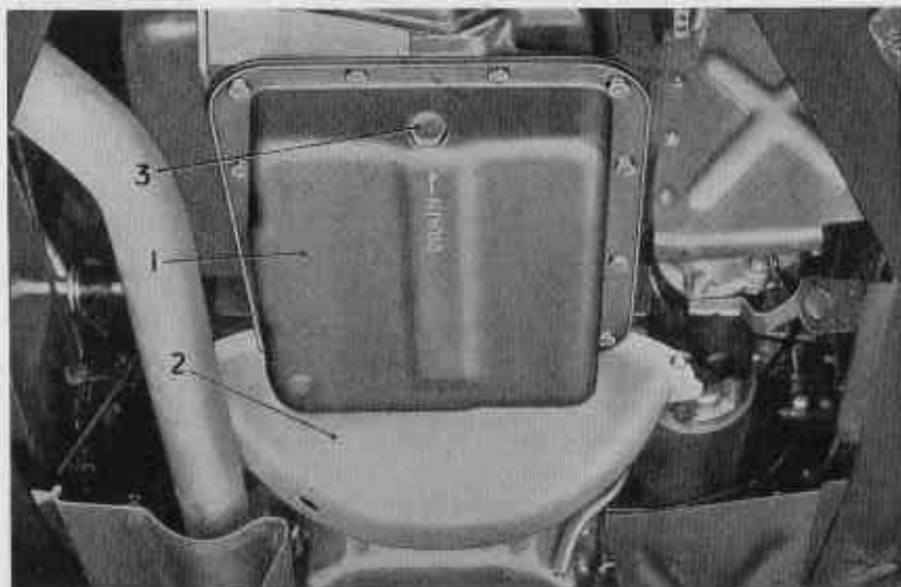
Fig. 23.—BOÎTE DES VITESSES, VUE DE DESSOUS.
