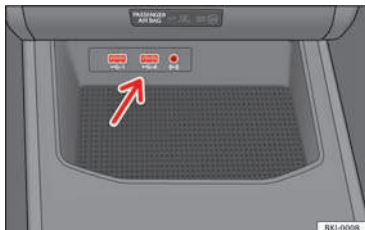
Fig. 111 Centre console: USB/AUX-IN input.
