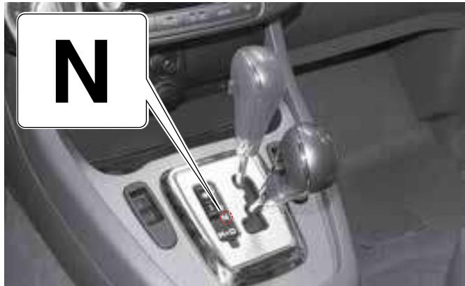
При этом положении рычага крутящий момент двигателя к коробке передач не поступает.
