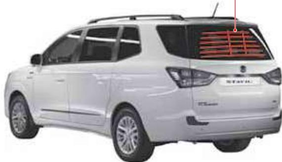
На стекло двери багажного отделения нанесены токоведущие нити обогревателя заднего стекла. Будьте осторожны, чтобы не повредить нити при очистке внутренней поверхности стекла задней двери.
