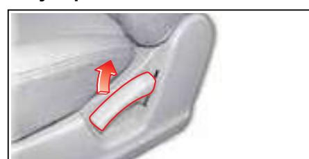
Чтобы отрегулировать положение спинки, немного наклонитесь вперед и потяните рычаг вверх. Затем обопрitezься на спинку, найдите удобное положение и отпустите рычаг. После того как регулировка была выполнена, убедитесь в том, что рычаг вернулся в исходное положение и спинка надежно зафиксировалась.
