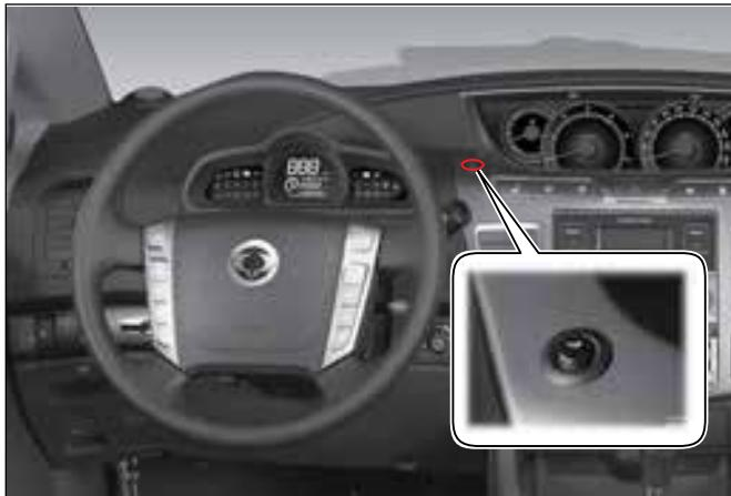
При нажатии данного переключателя на ЖК-дисплей можно выводить различную информацию, относящуюся к автомобилю.
