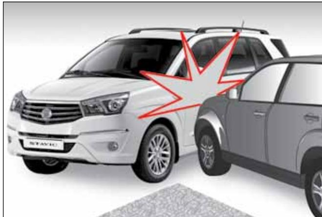
Передние подушки безопасности могут не раскрыться при боковом столкновении, поскольку находящихся в салоне людей отбрасывает в сторону удара и, следовательно, срабатывание передних подушек безопасности не сможет обеспечить должной защиты.
