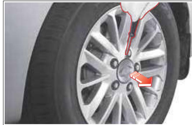
6. Отделите декоративную крышку от колесного диска, поддев ее отверткой с плоским лезвием.
