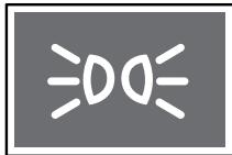
Данный индикатор загорается при включении габаритных или противотуманных фар.
