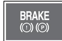
Если контрольная лампа ABS и контрольная лампа тормозной системы загораются одновременно, значит, обнаружена неисправность в системе EBD (система распределения тормозных усилий). При этом антиблокировочная система (ABS) также не действует.
