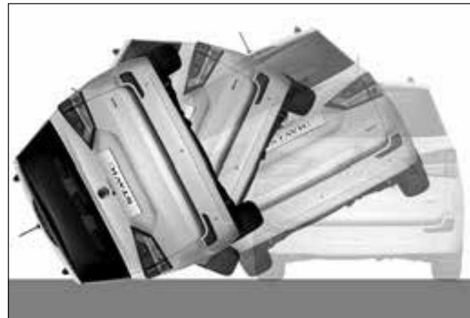
Подушки безопасности могут не сработать при опрокидывании автомобиля, поскольку в этом случае подушки не обеспечивают надлежащей защиты водителя и пассажиров.
