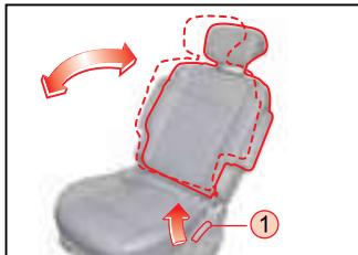
Чтобы отрегулировать положение спинки, немного наклонитесь вперед и потяните рычаг вверх ①. Затем обопрitezься на спинку, найдите удобное положение и отпустите рычаг. Рычаг предназначен для регулировки угла наклона спинки в определенном диапазоне.
