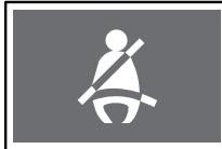
Данная контрольная лампа мигает, и в течение 6 минут подается звуковое предупреждение, если ключ зажигания находится в положении ON и водитель не пристегнут ремнем безопасности. Лампа и звуковое предупреждение отключаются до истечения вышеуказанного времени, в момент, когда застегивается ремень безопасности водителя.
