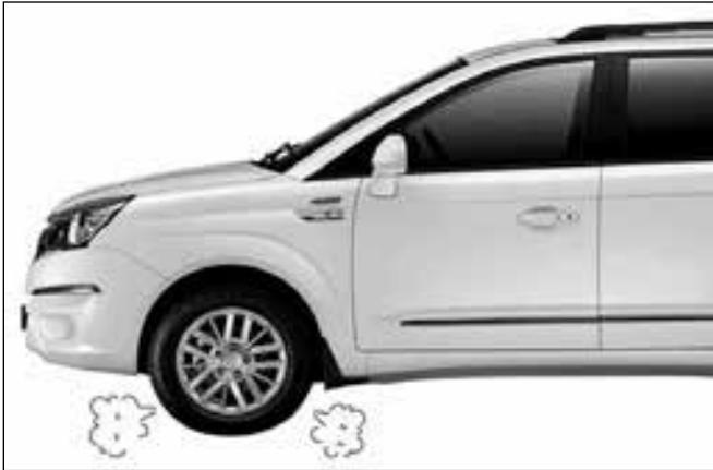
В случае прокола одной из шин во время движения надежно удерживайте рулевое колесо и уберите ногу с педали акселератора. Постепенно снижьте скорость и припаркуйте автомобиль в безопасном месте. Замените колесо с поврежденной шиной запасным (аварийным) колесом. Описание процедуры приведено в соответствующем разделе.
