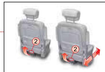
Чтобы отрегулировать продольное положение сиденья, потяните рычаг продольной регулировки ② вверх и переместите сиденье вперед или назад. Затем отпустите рычаг в выбранном положении.
