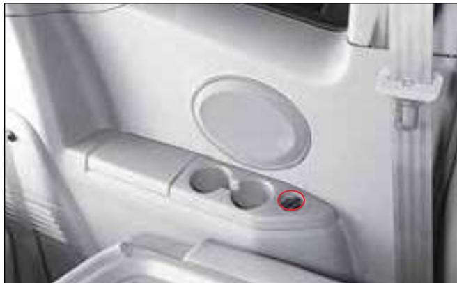
Дополнительная розетка для подключения электроприборов. Питание к розетке подается, когда ключ замка зажигания находится в положении ACC или ON.
