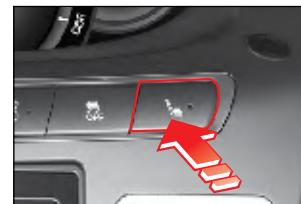
Нажмите кнопку для включения обогрева. Для выключения обогрева нажмите кнопку повторно.
