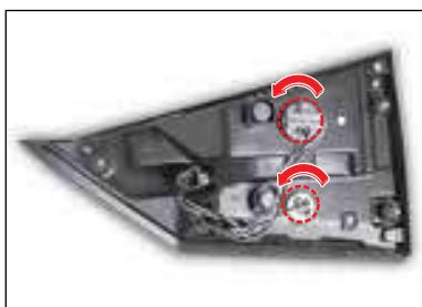
6. Нажмите на лампу и поверните ее, чтобы извлечь из патрона (лампы стоп-сигнала и габаритного огня). Потяните лампу, чтобы извлечь ее из патрона (лампа фонаря заднего хода).
