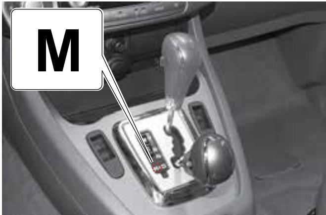
При установке рычага селектора в данное положение можно осуществлять выбор передач в ручном режиме при помощи переключателя, расположенного на рукоятке рычага, или при помощи кнопочных переключателей на пульте ДУ рулевого колеса.
