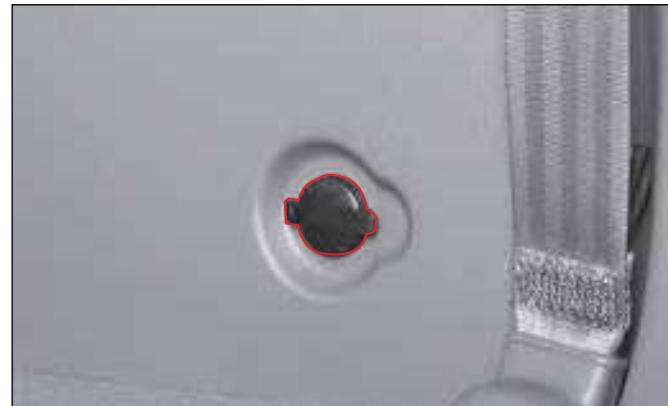
Доступ к розетке на правой панели кузова обеспечивается при откинутых сиденьях четвертого ряда.
