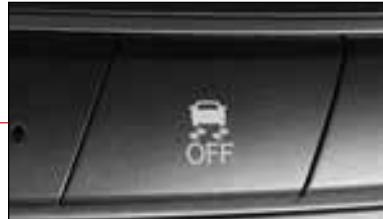
При нажатии выключателя ESP OFF система ESP отключается и на комбинации приборов загорается контрольная лампа ESP OFF.
