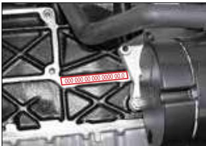
**Бензиновый двигатель:** номер двигателя выбит на нижней части блока цилиндров со стороны выпускного коллектора.
