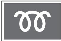
Данная контрольная лампа загорается при переводе ключа зажигания в положение ON, остается включенной в течение короткого промежутка времени или сразу гаснет. Когда свечи накаливания достаточно нагрелись, лампа гаснет.
