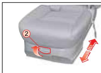
Чтобы отрегулировать продольное положение сиденья, потяните рычаг ② продольной регулировки вверх и переместите сиденье вперед или назад. Затем отпустите рычаг в выбранном положении.
