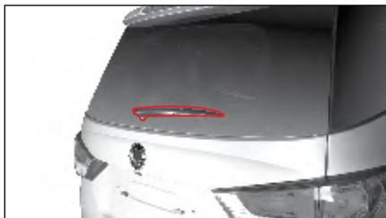
1. Извлеките ключ из замка зажигания и отведите рычаг очистителя от заднего стекла.
