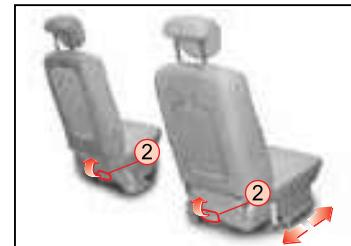
Чтобы отрегулировать продольное положение сиденья, потяните рычаг продольной регулировки вверх и переместите ② сиденье вперед или назад. Затем отпустите рычаг в выбранном положении.
