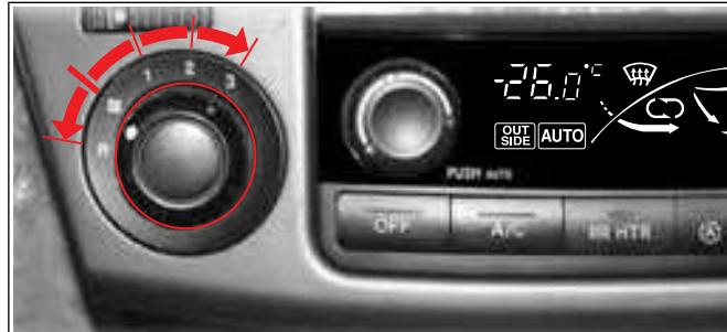
2. Включение системы отопления осуществляется путем нажатия выключателя RR HTR. Включение системы кондиционирования осуществляется путем нажатия выключателя A/C.
