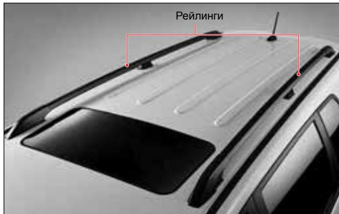
Если автомобиль оборудован рейлингами для перевозки багажа и установки верхнего багажника, перевозку багажа можно осуществлять на крыше автомобиля.
