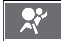
При включении зажигания эта контрольная лампа загорается, а затем должна погаснуть, информируя водителя о том, что система исправна.
