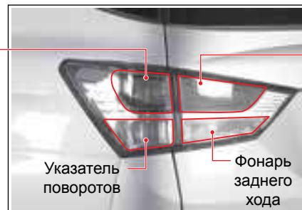
Стоп-сигнал/задний габаритный огонь
