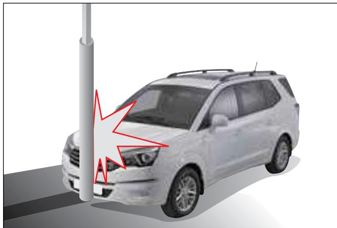
Подушки безопасности могут не сработать при столкновении автомобиля со столбом или деревом, так как в этом случае площадь удара слишком мала и датчики столкновения могут не определить реальную силу удара.
