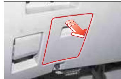
Блок предохранителей, расположенный в салоне, находится в левой торцевой части панели приборов.
