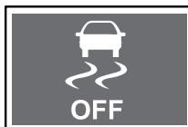
Данный индикатор загорается при переводе ключа зажигания в положение ON и должен гаснуть спустя несколько секунд.
