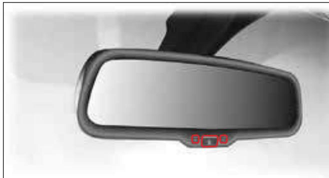
Отражающая способность внутреннего зеркала заднего вида может быть автоматически изменена в зависимости от яркости света фар приближающихся сзади транспортных средств, если нажать кнопку выключателя функции автоматического затемнения. При нажатии кнопки на зеркале загорается соответствующий светодиод. При повторном нажатии кнопки функция отключается и светодиод гаснет.
