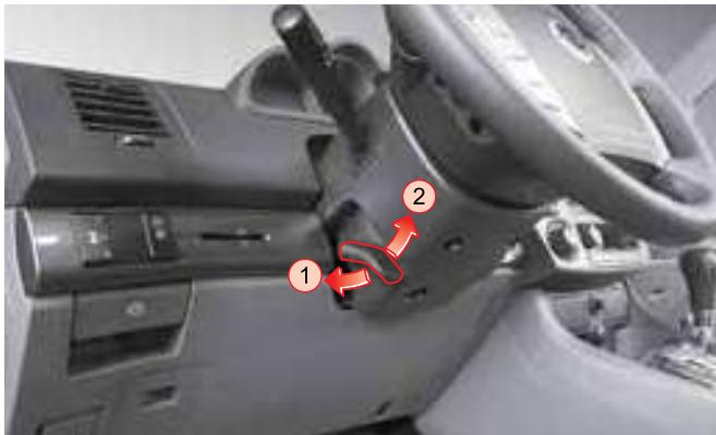
Рулевая колонка регулируется по наклону для обеспечения возможности выбора оптимального положения. Для регулировки положения рулевой колонки переместите рычаг в направлении, показанном стрелкой ①, и установите рулевое колесо в требуемое положение. Зафиксируйте рулевую колонку, перемещая рычаг в направлении, указанном стрелкой ②.
