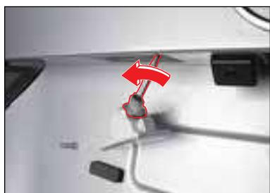
3. Вращая разъем против часовой стрелки, отсоедините его и извлеките патрон лампы.
