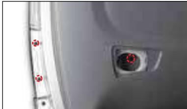
4. Отсоедините разъем и снимите задний комбинированный фонарь в сборе.
