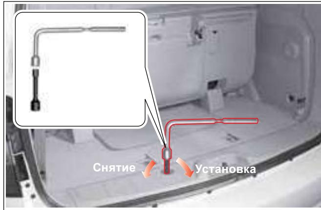
5. Соедините колесный ключ с удлинителем для снятия запасного колеса и установите удлинитель в отверстие. Чтобы снять запасное колесо, вращайте рукоятку ключа против часовой стрелки.
