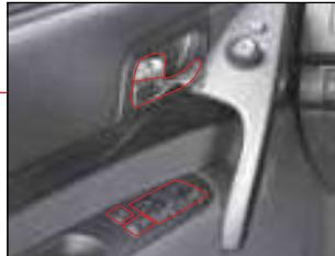
**Рычаг привода защелки
