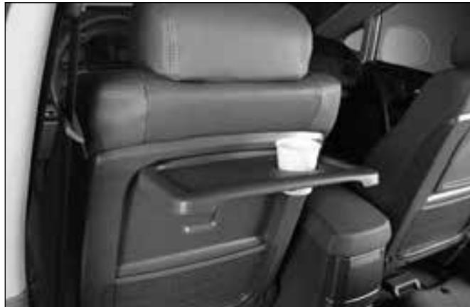
Столики установлены на тыльной стороне спинок передних сидений. Для пользования столиком поднимите его вверх до горизонтального положения. Если столик не используется, опустите его в исходное положение.
