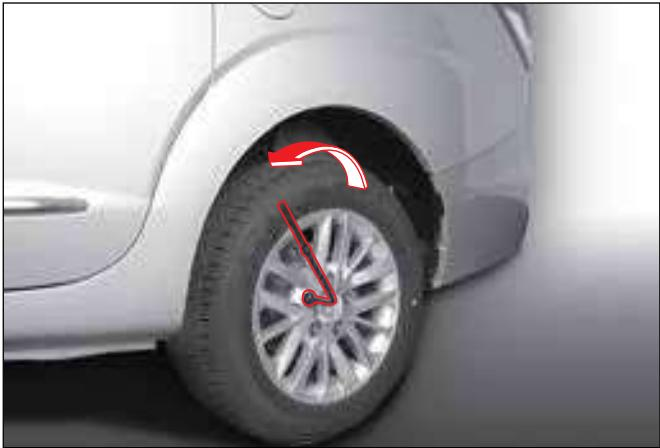
7. Ослабьте затяжку гаек крепления колеса на один или два оборота, поворачивая их против часовой стрелки при помощи колесного ключа.
