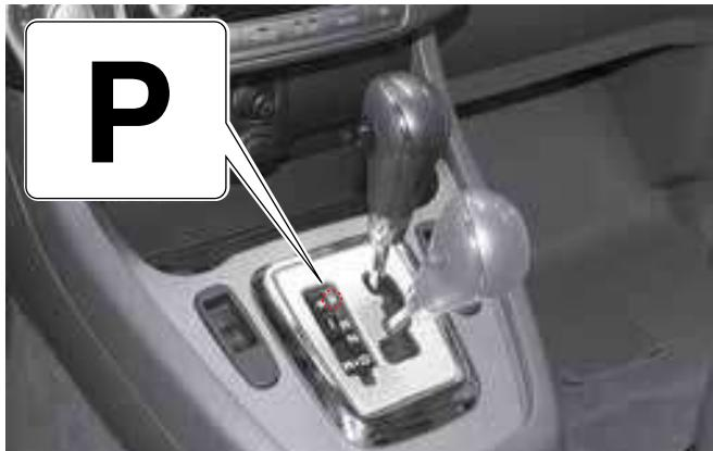
Устанавливайте рычаг в это положение при неподвижном автомобиле, а также во время запуска/прогрева двигателя и при длительной остановке. Для перевода рычага в другое положение необходимо нажать педаль тормоза; при этом ключ зажигания должен находиться в положении **ON**.
