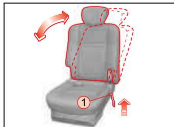
Чтобы отрегулировать положение спинки, немножко наклонитесь вперед и потяните рычаг вверх. Затем обопритесь на спинку, найдите удобное положение и отпустите рычаг. Рычаг предназначен для регулировки угла наклона спинки в определенном диапазоне.
