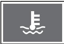
Когда температура охлаждающей жидкости превышает максимально допустимое значение, данная контрольная лампа начинает мигать и подается звуковое предупреждение. В этом случае необходимо остановить автомобиль в безопасном месте и дать двигателю остыть. Более подробная информация приведена в главе 11 «Перегрев двигателя».
