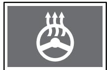
Данный индикатор включается при нажатии выключателя обогрева рулевого колеса на рулевом колесе и выключается при повторном нажатии выключателя.
