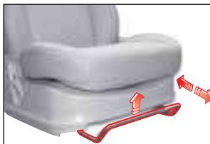
Чтобы отрегулировать продольное положение сиденья, потяните рычаг продольной регулировки вверх и переместите сиденье вперед или назад. Затем отпустите рычаг в выбранном положении.
