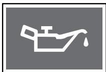
Данная контрольная лампа загорается при включении зажигания и гаснет после запуска двигателя.
