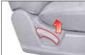
Чтобы отрегулировать положение спинки, немножко наклонитесь вперед и потяните рычаг вверх. Затем обопрitezься на спинку, найдите удобное положение и отпустите рычаг. После того как регулировка была выполнена, убедитесь в том, что рычаг вернулся в исходное положение и спинка надежно зафиксировалась.
