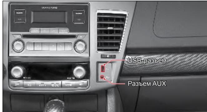
В автомобиле установлены USB-разъем и дополнительный аудиовход (AUX).
