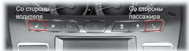
Нажмите кнопку выключателя для включения обогревателя. Для отключения обогревателя нажмите кнопку выключателя еще раз. При включенном обогревателе на кнопке выключателя горит светодиод.
