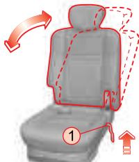
Чтобы отрегулировать положение спинки, немножко наклонитесь вперед и потяните рычаг вверх. Затем обопритесь на спинку, найдите удобное положение и отпустите рычаг. Рычаг предназначен для регулировки угла наклона спинки в определенном диапазоне.
