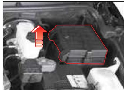
Блок предохранителей моторного отсека расположен с правой стороны моторного отсека.
