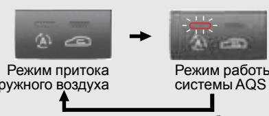
Для перехода в режим рециркуляции во время работы системы кондиционирования в автоматическом режиме переключите систему в режим ручного управления и нажмите выключатель выбора источника забора воздуха.
