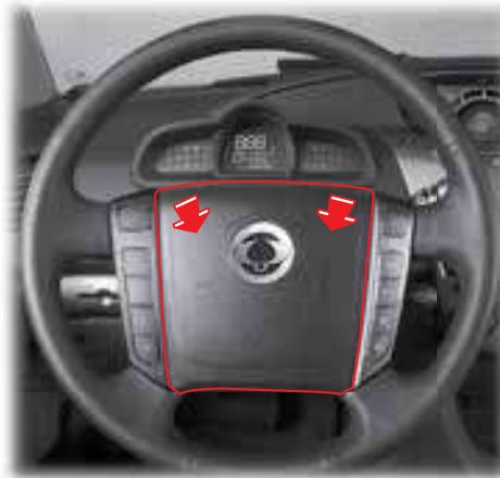
Для подачи звукового сигнала необходимо нажать на декоративную крышку рулевого колеса.
