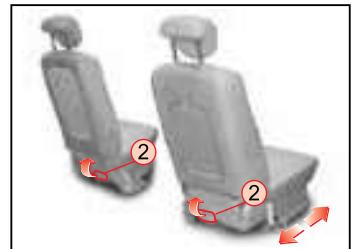
Чтобы отрегулировать продольное положение сиденья, потяните рычаг ② продольной регулировки вверх и переместите сиденье вперед или назад. Затем отпустите рычаг в выбранном положении.
