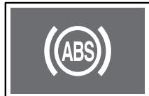
Данная контрольная лампа загорается при переводе ключа зажигания в положение ON и должна гаснуть спустя несколько секунд.
