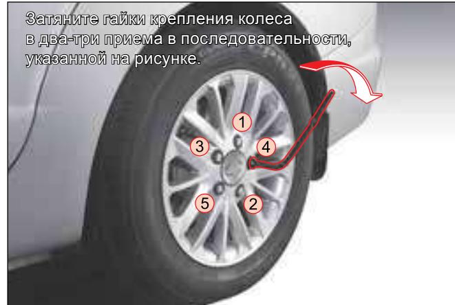
12. Установите запасное колесо и наживите гайки крепления колеса вручную.
