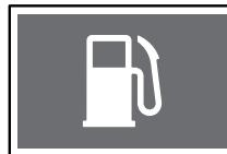
Данная контрольная лампа предупреждает о том, что в баке заканчивается топливо. Момент включения контрольной лампы зависит от условий движения, например от характера уклона дороги и других неровностей. При включении данной контрольной лампы во время движения при первой же возможности произведите дозаправку топливом. Рекомендуется заправлять топливо заранее, до включения данного сигнала.
