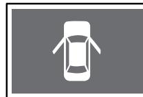
Данная контрольная лампа загорается, когда двери автомобиля открыты или закрыты неплотно. Данная контрольная лампа мигает при движении автомобиля со скоростью более 10 км/ч с незакрытой дверью.
