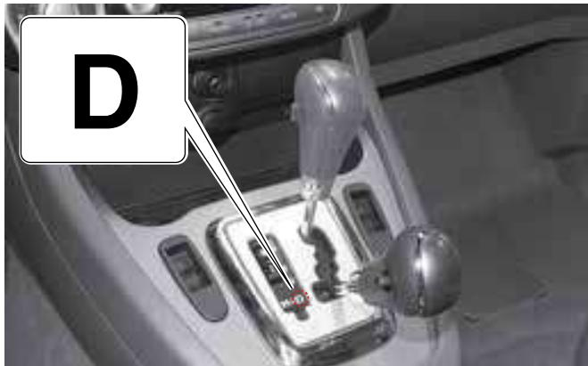
Данное положение рычага предназначено для осуществления движения в обычном режиме. Коробка передач автоматически выполняет выбор и переключение передач с 1-й по 5-ю в зависимости от степени нажатия педали акселератора и условий движения автомобиля.
