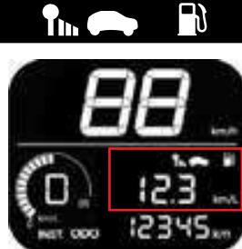
В данном режиме производится расчет среднего расхода топлива на основании общего количества израсходованного топлива и расстояния, пройденного с момента последнего обнуления показаний счетчика среднего расхода топлива.
