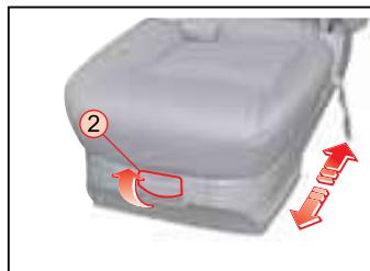
Чтобы отрегулировать продольное положение сиденья, потяните рычаг продольной регулировки вверх и переместите ② сиденье вперед или назад. Затем отпустите рычаг в выбранном положении.
