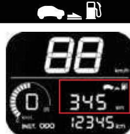
В данном режиме на дисплее отображается расчетный показатель расстояния, которое может пройти автомобиль при оставшемся количестве топлива в топливном баке.
