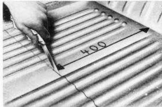
Bild 27. Lage der Trennlinie im Bodenblech
