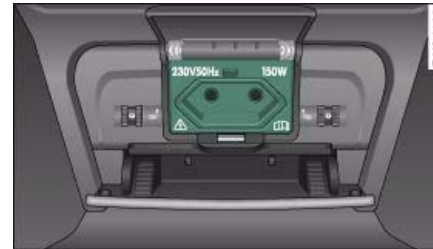
Fig. 103 Rear centre console: 230 Volt Euro socket
