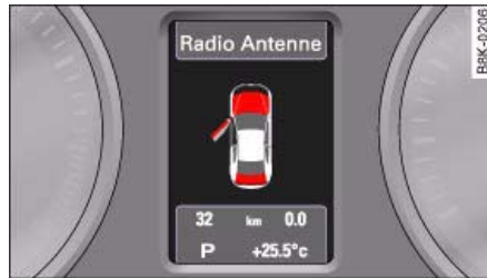
Fig. 14 Display: Door catches/boot lid warning
