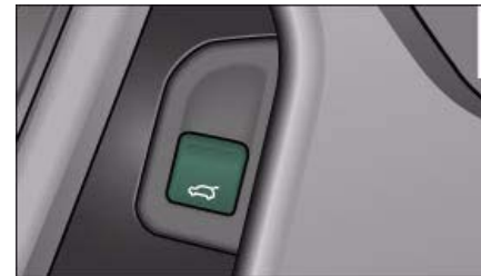
Fig. 42 Driver's door: Unlocking the boot lid ►
