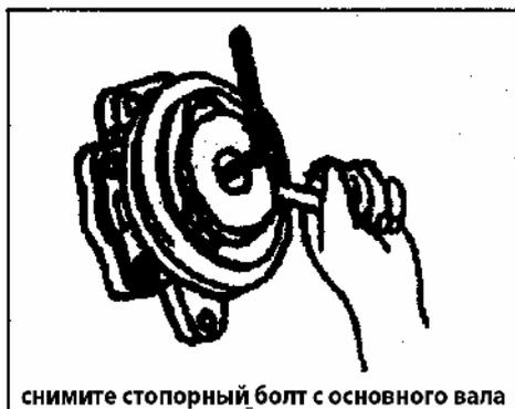
снимите стопорный болт с основного вала
