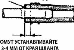
ПРИ ОДЕВАНИИ ШЛАНГА НА ИЗОГНУТЮЮ ТРУБКУ, ОДЕВАЙТЕ ШЛАНГ НА 20-30 ММ
