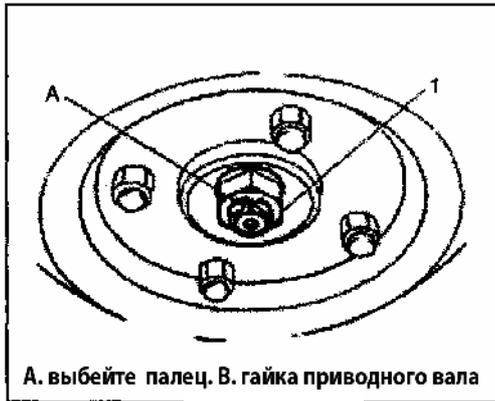
А. выбейте палец. В. гайка приводного вала
